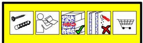
**PL** Uwaga! Ścianę należy sprawdzić przed montażem. Doliczone uniwersalne kolki rozporowe są odpowiednie tylko do stosowania w mocnych murach, takich jak beton lub cegla. Nie rób za pomocą kolków zoporowych murowanych, takich jak pustak, lekka kostka, powierzchnie takie jak płyty gipsowo-kartlowe lub inne systemy ram. Jeśli dotyczy, muszą to być określone kolki rozporowe być użyty! Są one dostępne w specjalistycznym sklepie / producent / sprzedawca lub importer nie ponoszą odpowiedzialności.
