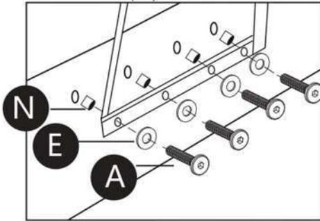
SK/ Krok 6: Pripevnite plynový zdvihadací mechanizmus (3 a 4) k bočným lištám 6 a 7 pomocou kovania N, E a A.
