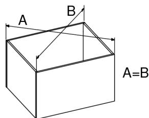
Zadnji korak je postavitev pohištva na pravo mesto in preverjanje z vodno tehniko navpični in vodoravni položaj pohištva ter nastavitev sprednjih površin na tečajih.
